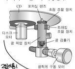
안의 광**/**검출기가 받아들인다. 광선의 경로 상에 있는 <u>포커싱</u> 렌즈는 광선을 트랙의 한 지점에 모으고, 광 검출기는 <u>반사된</u> 광선의 양을 측정하여 랜드와 피트의 정보를 읽어 낸다. 이때 학교 대표 레스의 초점이 맞지 않으면 광 검출기의 <del>전 영역과 후 영역의</del> CD의 회전 속도에 맞춰 트랙에 광선이 조사될 수 있도록 광 학계 구동 모터가 광 픽업 장치를 CD의 중심부에서 바깥쪽으 로 서서히 직선으로 이동시킨다. 들이 (701-46년에 격인으로 어둡니고)
